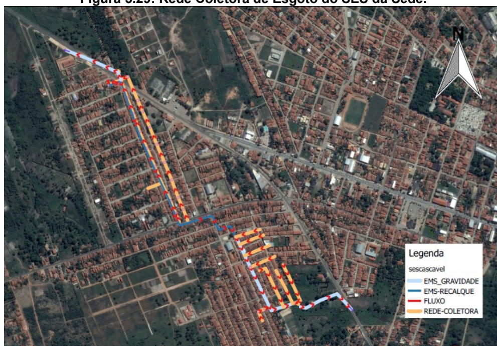
Figura 5.29: Rede Coletora de Esgoto do SES da Sede.
